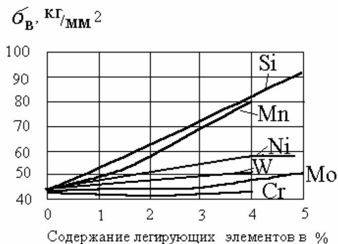
Рис.8.1. Зависимость \sigma_v стали от содержания легирующих элементов в феррите
