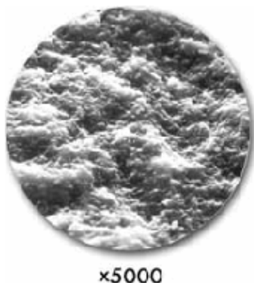
Рис. 16.5. Поверхность углеситалла при 5000 увеличении
